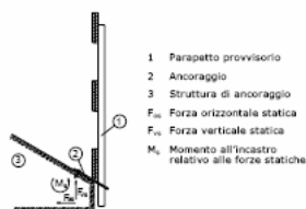
Fig. 8.1-1 Esempio di reazioni vincolari relative alle azioni statiche
