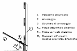
Fig. 8.1-2 Esempio di reazioni vincolari relative alle azioni dinamiche
