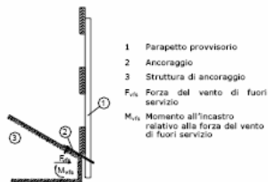
Fig. 8.1-3 Esempio di reazioni vincolari relative all'azione del vento di fuori servizio
